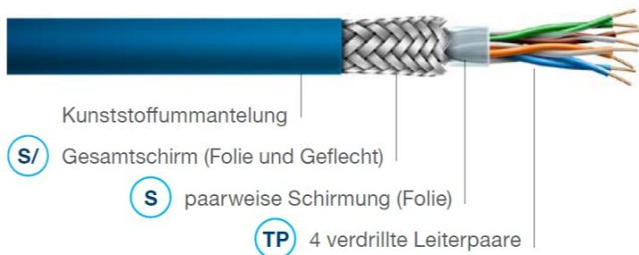
Die Summe von Schirmdämpfung und Symmetriedämpfung ist bei geschirmten Datenleitungen die **Kopplungs-dämpfung**. Sie bietet die Möglichkeit der Beurteilung und des Vergleichs des Gesamtverhaltens von Datenkabeln mit unterschiedlichem Aufbau hinsichtlich der EMV.
