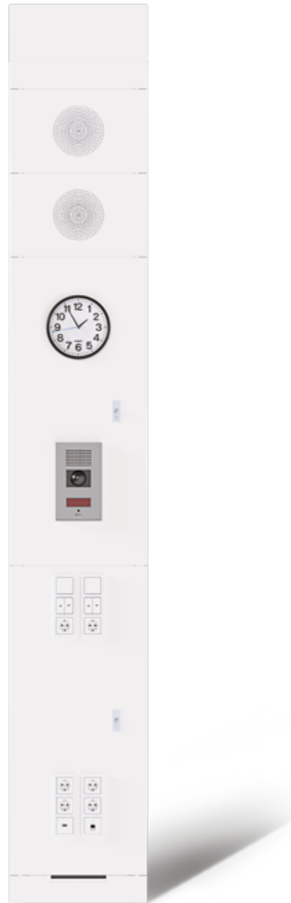
Mediensäule Typ 2 Die Oberteile sind im Seitenprofil verschraubt und somit seitlich überstehend. (Breite Frontseite: 490 mm, Breite Rückseite: 430 mm, Tiefe: 181,5 mm)
