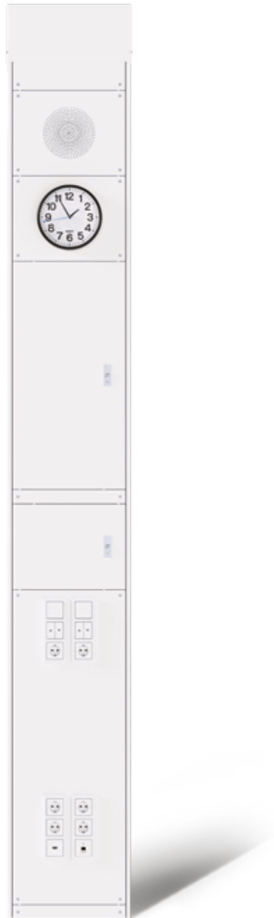
Mediensäule Typ 1: Die Oberteile sind frontseitig verschraubt und somit bündig mit dem Unterteil. Die Scharniere sind justierbar und werkzeuglos demontierbar. (Breite 430 mm, Tiefe 180 mm)
