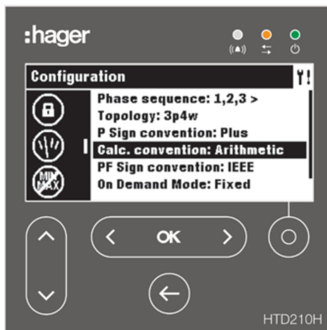
Menu Configuration (Configuratie) HTD210H paneeldisplay
