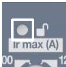
L'accès aux modifications de réglage ou à la réinitialisation des mesures via l'afficheur embarqué est protégé par une fonction de verrouillage. L'afficheur embarqué peut être
