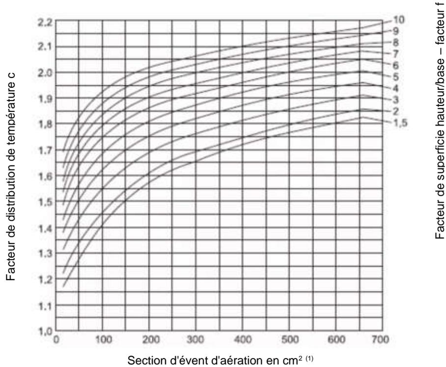
1) La taille de la section des événements d'aération associés doit être d'au moins 1,1 fois celle des ouvertures d'entrée d'air
