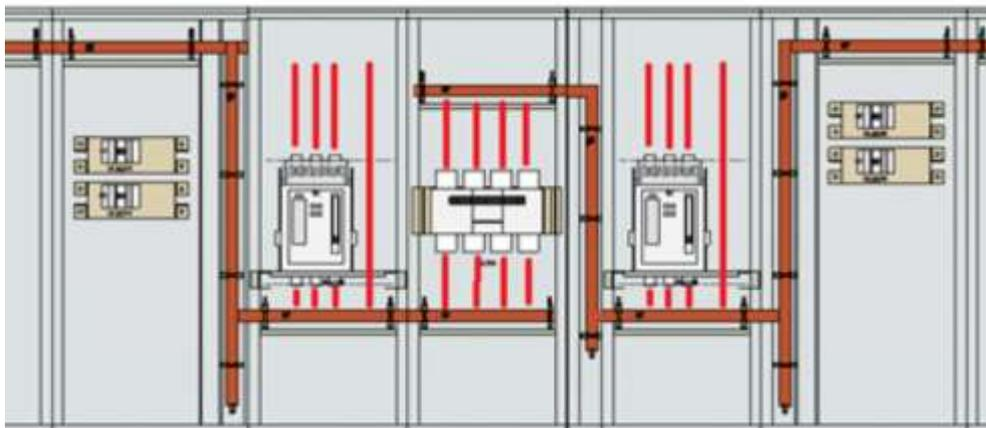
Si les appareils d'alimentation entrants sont positionnés aux extrémités, l'interrupteur de couplage doit être positionné entre les deux jeux de barres.
