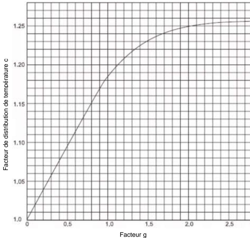
**Formulaire de calcul de la hausse de température de l'air dans l'armoire**
