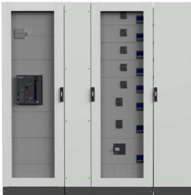
Pour atteindre un indice de protection IP55, des panneaux latéraux et une porte équipés de joints doivent être fixés à la structure de la cellule. Dans la version IP55, les cellules quadro evo ont une résistance aux chocs de IK10 et la poignée de porte est un levier pivotant avec bouton-poussoir.
