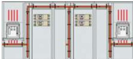
**Armoire d'arrivée multiple sur  $ACB \leq 2 \times 2\,000\text{ A}$**
