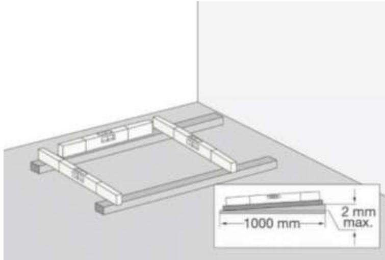
Les socles des différentes cellules doivent être fixés au sol.
