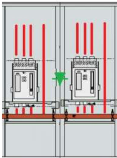
Les ACB doivent être positionnés côte à côte pour permettre un verrouillage mécanique entre les deux appareils.
