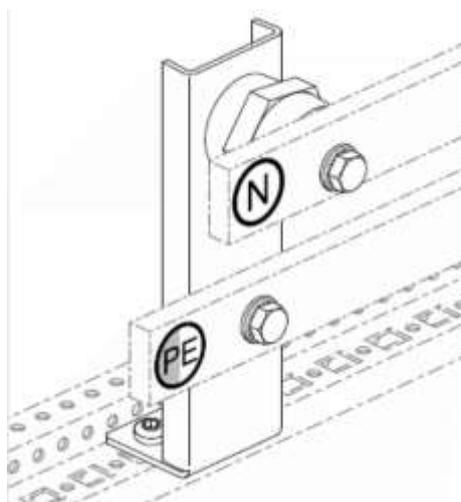
Pour les circuits de départ plus petits qui sont acheminés via des borniers, un bornier de conducteur de protection est requis par rail DIN avec borniers de sortie pour la connexion de conducteur de protection (par ex. KYA...). Le bornier et le câblage du jeu de barres en cuivre du conducteur de protection central doivent être conçus en fonction des valeurs techniques des circuits de départ.
