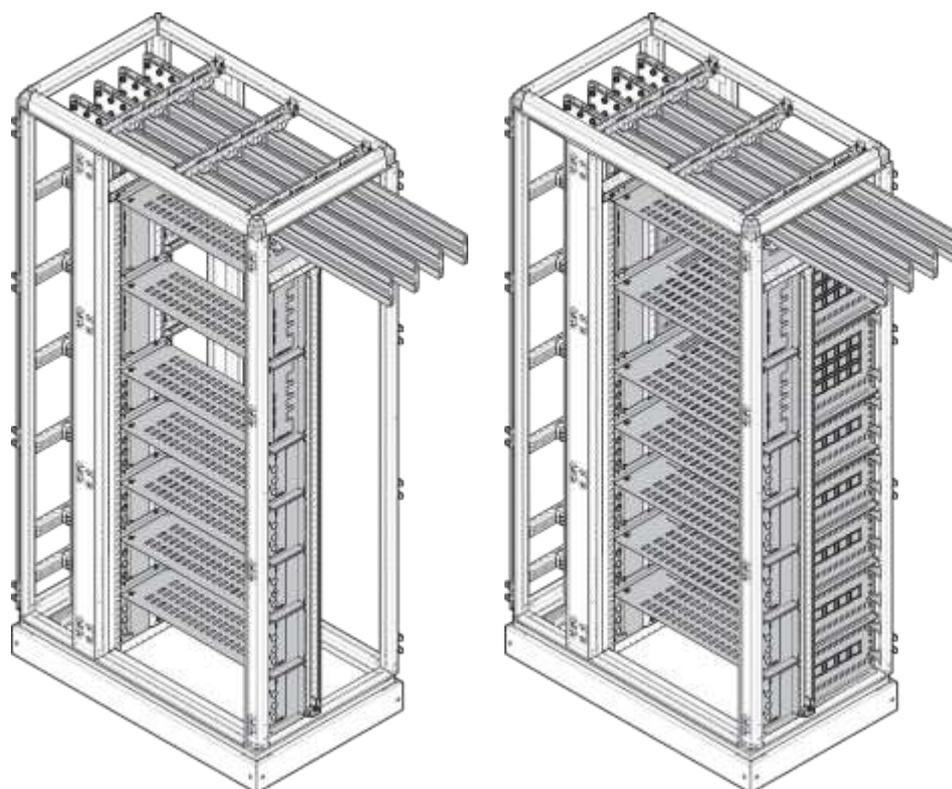
Le cloisonnement de la forme 3 de boîtier moulé se fait par le biais de plaques de cloisonnement horizontales standard, installées entre chaque kit de boîtier moulé. Tenez compte du type de connexion du type d'appareil, à l'avant ou à l'arrière. Les connexions à l'arrière nécessitent un cloisonnement total, également derrière la platine de montage du kit.
