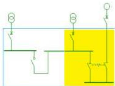
Pour cette combinaison d'appareils d'alimentation d'arrivée, suivez les mêmes principes que pour la combinaison avec un interrupteur principal et un inverseur de source (ATS) (partie jaune du dessin) et positionnez le deuxième appareil d'arrivée et l'interrupteur de couplage dans les cellules de l'autre côté des jeux de barres.
