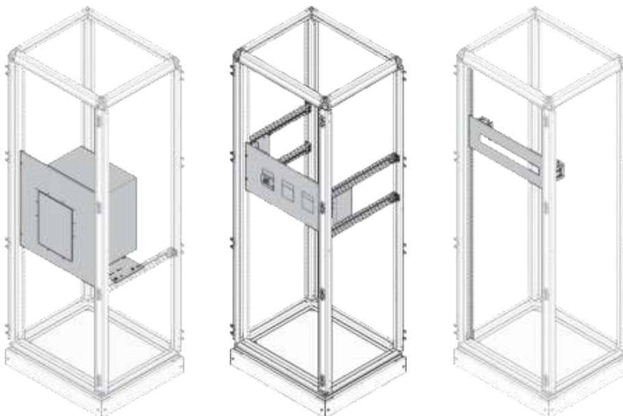
Les ACB doivent être installés sur des traverses latérales
