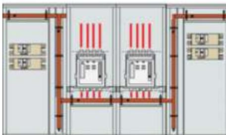
**Tous les interrupteurs principaux placés aux extrémités gauche et droite de l'ensemble.**
