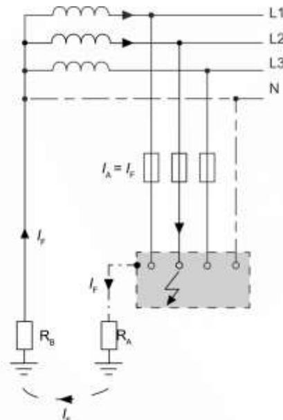
Dans le cas du système TT, la boucle de défaut est formée par un conducteur externe et le chemin via  $R_A$  et  $R_B$ .
