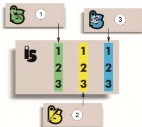
Le premier chiffre (première colonne en vert), « Exploitation », détermine les conditions des interventions de séparation électrique et/ou de condamnation mécanique de tout ou partie d'une installation par tout type de personnel habilité.
