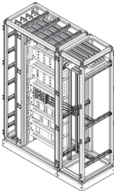
La cloisonnement de la forme 4 de boîtier moulé se fait par le biais de plaques de cloisonnement latérales standard, installées entre chaque boîtier moulé et la gaine à câbles, afin de garantir la séparation des bornes entrantes et sortantes. Les bornes doivent être séparées entre elles par d'autres barrières dans la gaine à câbles.
