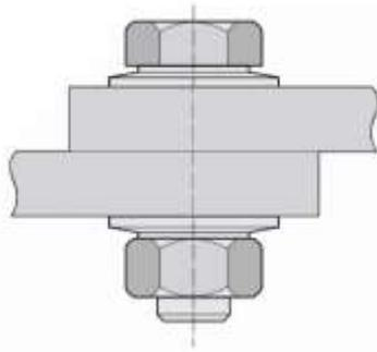
La longueur du boulon doit être calculée en fonction de l'empilage des pièces, des rondelles et de l'écrou. Le boulon doit dépasser d'au moins 2 filets après l'assemblage.
