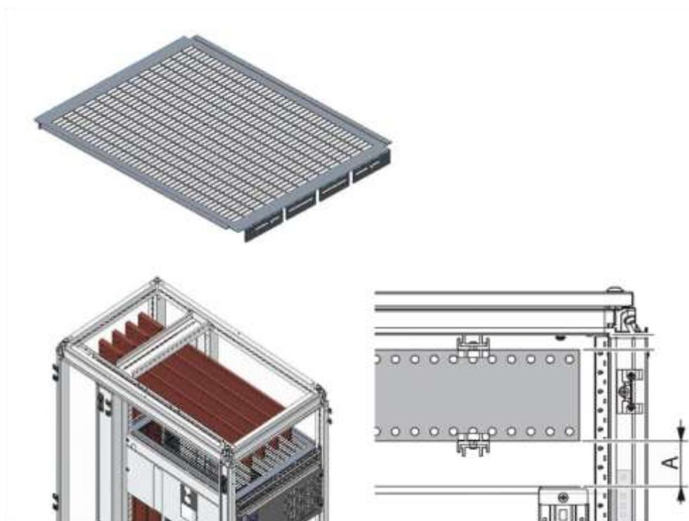
Afin de garantir une sécurité maximale en cas de court-circuit au niveau des jeux de barres, la partition horizontale doit se trouver à au moins 50 mm (côté A) des jeux de barres.
