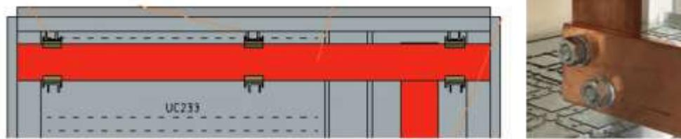
Pour la jonction d'un jeu de barres de distribution secondaire à partir du jeu de barres principal ( $I_n$  secondaire <  $I_n$  principal), avec un courant et une section plus faibles, la distance de chevauchement minimale à appliquer représente 5 fois l'épaisseur de la barre secondaire ; à partir de 6, le gain en efficacité est faible.
