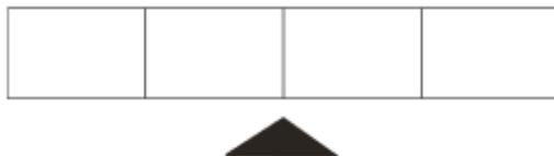
Les cellules ayant la même profondeur et la même hauteur peuvent être reliées dans le sens de la largeur grâce à des kits spécialement créés.
