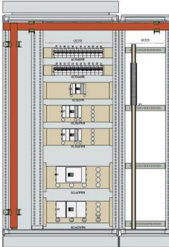
Dans les pages suivantes sont montrés plusieurs types de configuration pour effectuer des cellules de départ et d'arrivée sur le tableau. Ces configurations classiques peuvent être utilisées pour mettre en place un tableau conforme à la vérification de la conception de Hager. Les valeurs testées sont fournies dans leur intégralité. Ces changements de conception ne sont acceptables que s'ils découlent de conceptions testées.
