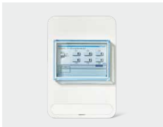
KNX easy ενεργοποιητής θέρμανσης 6 εξόδων με ενσωματωμένο ελεγκτή, TXM646R μέσα σε προστατευτικό κουτί για τοποθέτηση στο κολλεκτέρ της ενδοδαπέδιας θέρμανσης, TGC600
