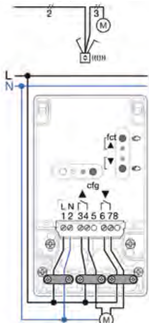
Εικόνα 1: Συνδεσμολογία ελέγχου μοτέρ ρολών
