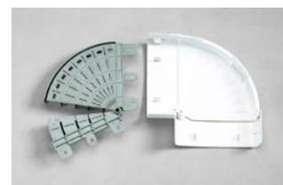
I cavi mantengono una perfetta separazione nei cinque scomparti anche nelle applicazioni più complesse grazie alla base dotata di setti separatori. Per ottenere tutte le escursioni necessarie - da 90° a 170° - è sufficiente tagliare fondo e coperchio seguendo le linee di prefabbratura graduate.
