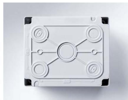
I fondi dei contenitori IP40 e IP55 sono caratterizzati da punti di fissaggio a muro con asole per facilitare la messa in bolla, e da prefettura centrale per l'ingresso con tubi corrugati diametri 16 e 20 mm.
