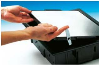
Una leva appositamente progettata facilita l'operazione di apertura volontaria della torretta a scomparsa NEST, la sede dedicata per il posizionamento del dito della mano ne agevola l'utilizzo. Il coperchio, nel rispetto di tutte le prescrizioni normative, si chiude spontaneamente per gravità. Per smontare completamente il coperchio è sufficiente posizionarlo in prossimità della verticale ed operare una trazione verso l'alto.
