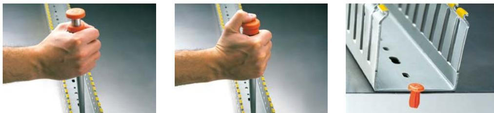
Sfruttando l'impugnatura ergonomica dell'utensile si inserisce facilmente il rivetto nel foro. Premendo l'estremità dell'applicatore si completa il fissaggio tramite l'inserzione del perno del rivetto. La divaricazione delle alette dell'elemento di fissaggio ne impedirà l'estrazione.
