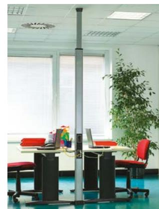
Altezza massima consentita dall'abbinamento del corpo colonna con il tubo telescopico: 4,9 metri. Si consiglia di inserire il tubo telescopico per almeno 50 cm nel corpo della colonna.
