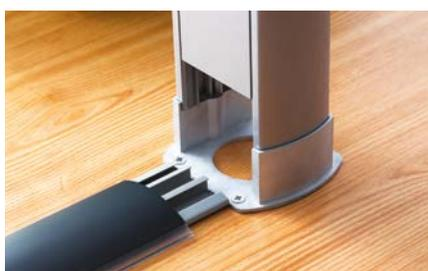
La colonna UNA è perfettamente integrabile con il canale sopra pavimento CSP-N. L'operazione da eseguire è estremamente semplice: è sufficiente mandare in battuta il canale alla base tecnica nella sede dedicata e tagliare il raccordo di finitura seguendo le opportune linee di riferimento.
