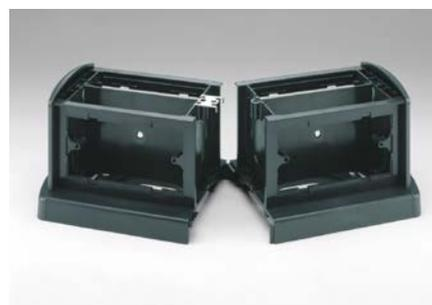
I telai devono essere agganciati con il gancio di unione torrette prima di avvitare i coperchi. L'ampliamento orizzontale si ottiene affiancando alla torretta porta apparecchi TOR una o più estensioni orizzontali TOR-O e completando l'assemblaggio con uno dei fianchi smontabili della TOR.
