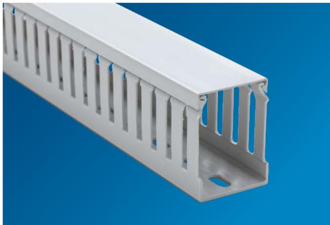
La gamma è Halogen Free per rispondere a ogni esigenza installativa. Si distingue per la semplicità di cablaggio con pre-fratture del fondo su 2 altezze e perfetta geometria della base e del coperchio per un fissaggio preciso e ordinato. Realizzata in ABS+PC è disponibile in 15 dimensioni: dalla 25x25mm alla 125x75mm lunghezza 2000mm, tutte modulo 12,5mm con feritoia 5mm. Il range di temperature può variare da -25°C a +90°C preservando i cablaggi da eventuali picchi termici.
