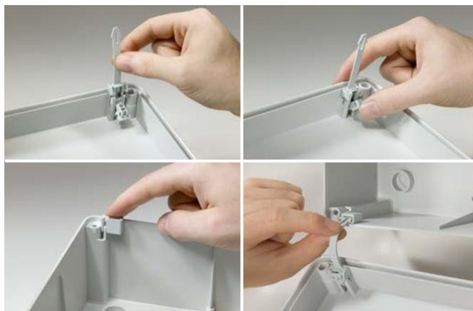
È possibile incernierare il coperchio al fianco del fondo delle cassette utilizzando la cerniera e la clip di fissaggio data in dotazione nelle cassette dalla dimensione 190x140 in poi sia nella versione IP55 che IP56.
